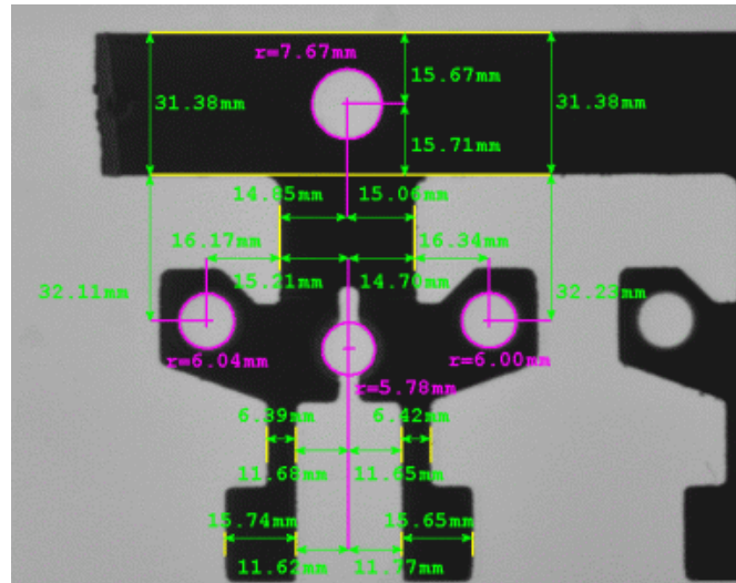
Şekil 2. Görüntü işleme ile boyut ölçümü [2].
