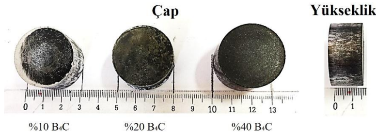
Şekil 3. Üretimi tamamlanan numunelere ait görseller; 30 mm çap ve 15 mm yükseklik.
