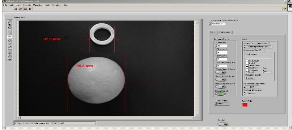
Şekil 4. Labview ile tarımsal ürün boyut ölçüm işlemi
