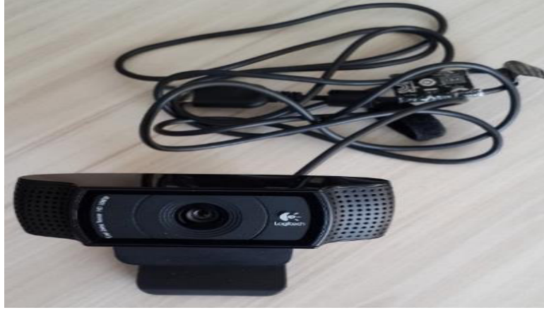
Şekil 3. Labview ile geliştirilen program ile kullanılan usb webcam (Logitech C920)
