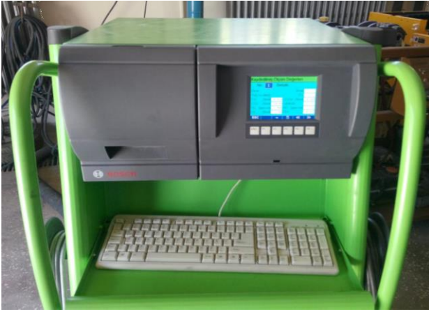
Şekil 2. Bosch BEA 350 egzoz emisyon analiz cihazı
