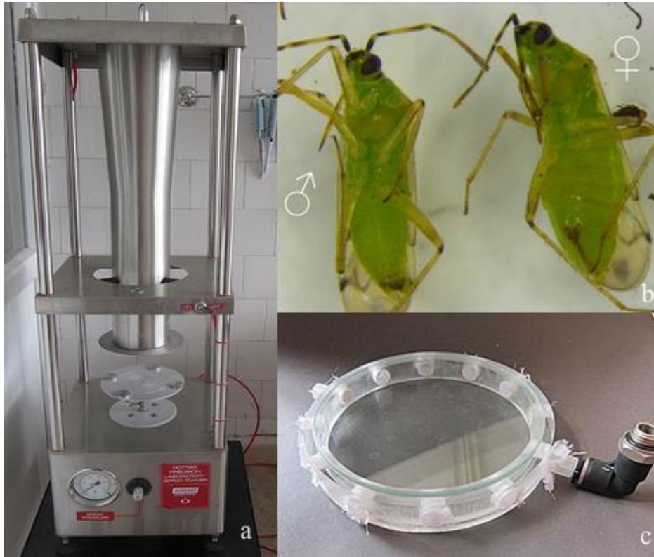
Şekil 1. Pestisitlerin uygulamasında kullanılan ilaçlama ünitesi (a), ergin hale gelmiş Nesidiocoris tenuis bireyleri (b), denemelerde kullanılan ilaçlı düzenek (c)
