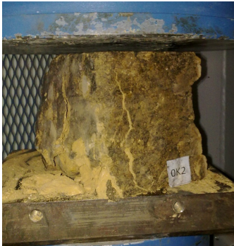
Resim 3. 0K2-56 Numunesinin basınç deneyi
