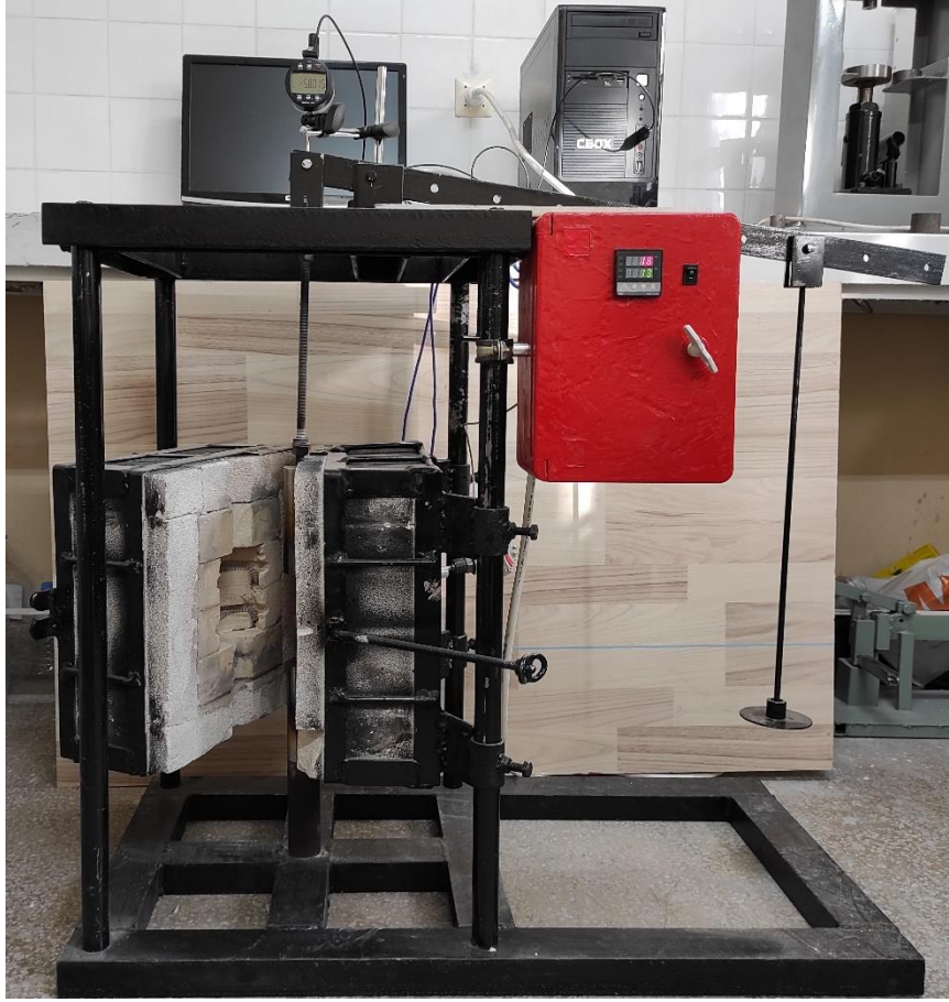
Şekil 8. Tasarlanan ve imalatı yapılan sürünme test cihazı
