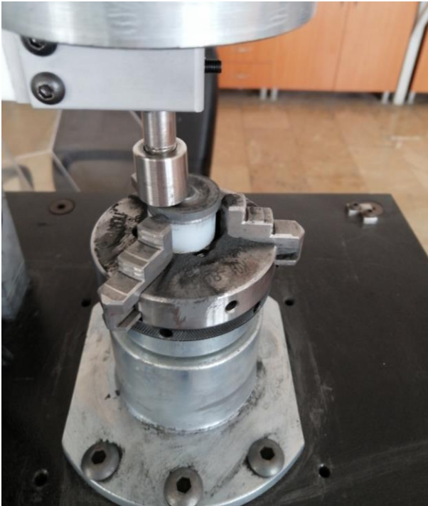
Şekil 1. Ball on disk aşınma deney düzeneği
