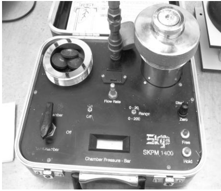
Şekil 3. Dijital çanta tipi Scholander basınç odası
