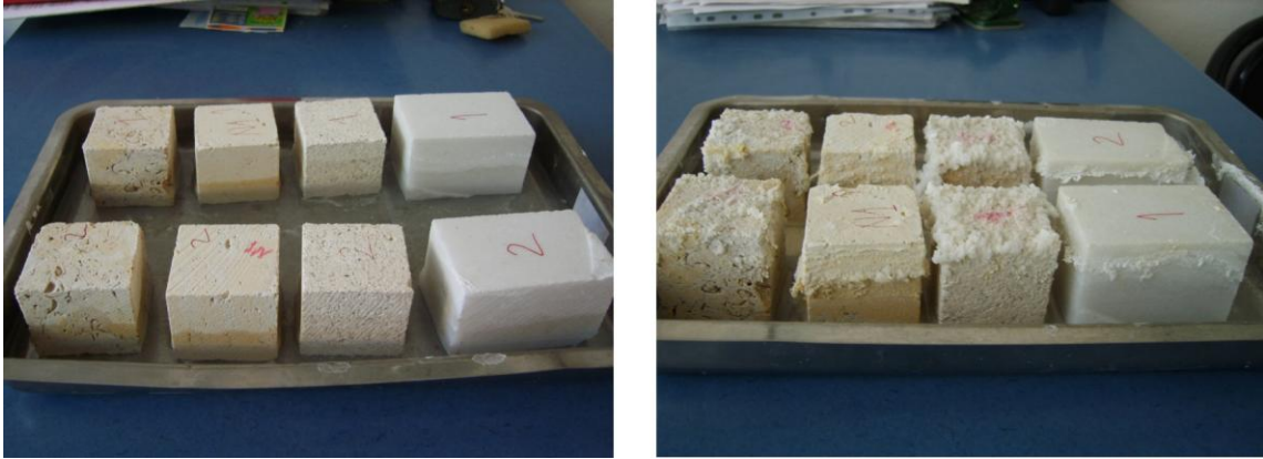
Şekil 5. Yapı taşlarının 15 gün süre ile %1 oranında \text{Na}_2\text{SO}_4 ile etkileşimi sonrası oluşan tahrip.
