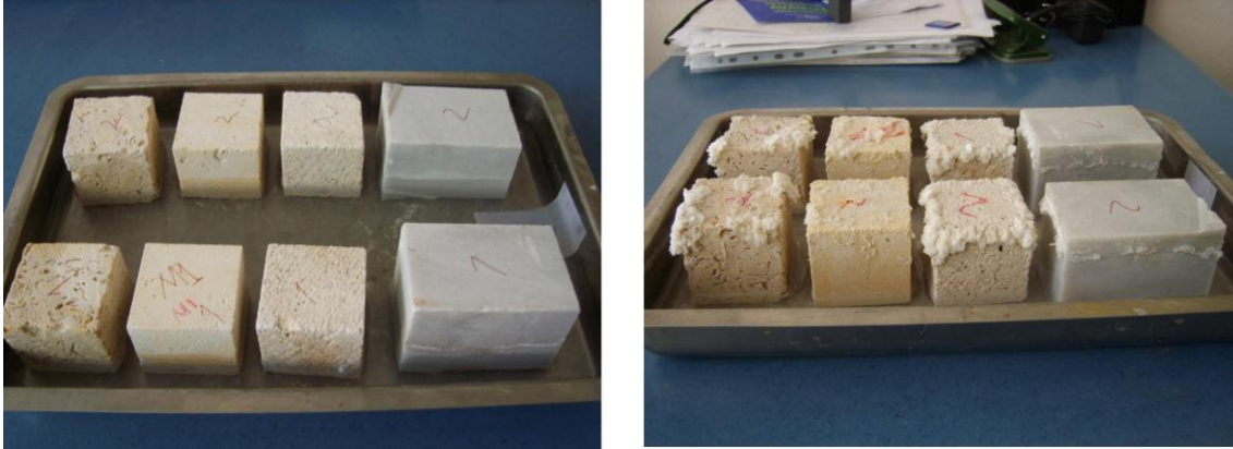
Şekil 3. Yapı taşlarının 15 gün süre ile %1 oranında MgSO_4 ile etkileşimi sonrası oluşan tahrip.
