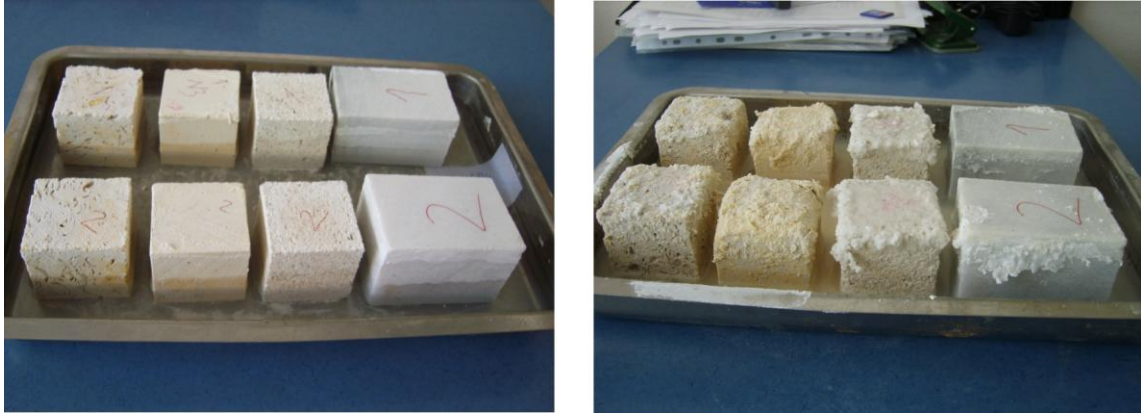
Şekil 6. Yapı taşlarının 15 gün süre ile %3 oranında Na 2 SO 4 ile etkileşimi sonrası oluşan tahrip.
