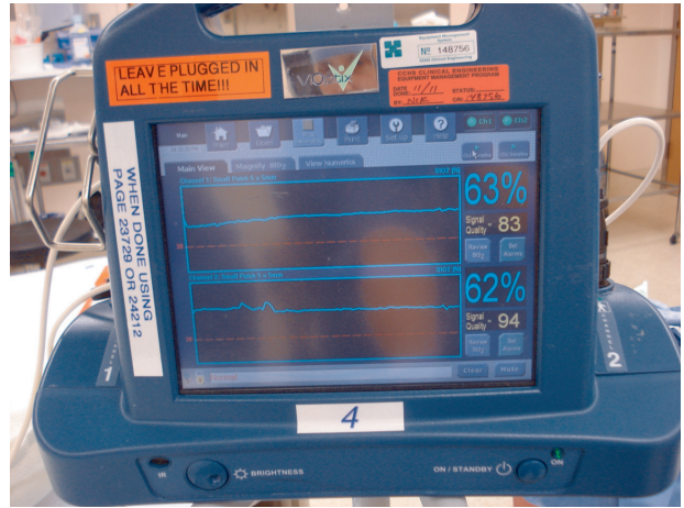
Şekil 6. Spektrofotometri sonuçları bilgisayar konsoluna yansıtılarak doku perfüzyonu yüzde olarak gösterilmektedir.
