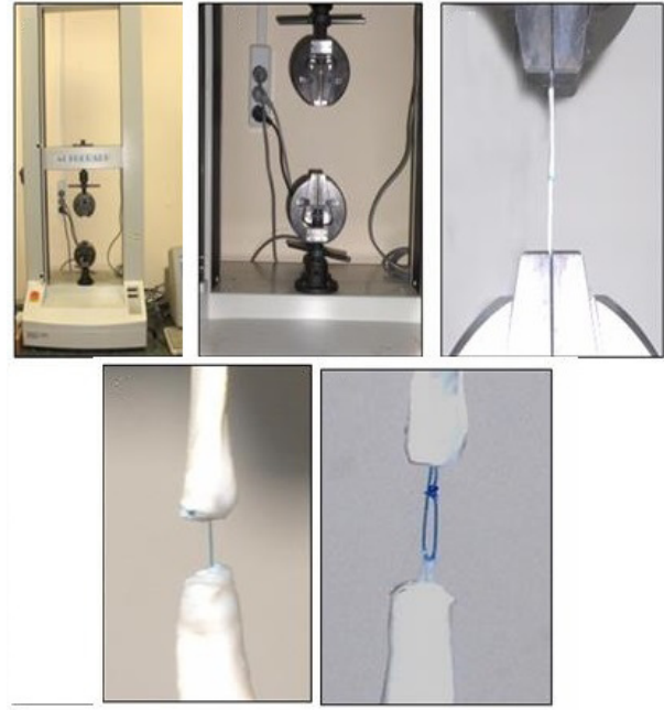
Şekil 7. 1kg yük hücresi ile uygulanan mekanik çekme testi. Altta görüntülerde tendon uçlarının ayrılma nedeni olarak dikiş kopması (sol alt) ve dikiş sıyrılması (sağ alt) gözlenmektedir.
