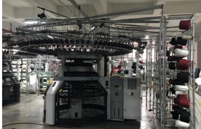
Şekil 6. Matelasse örme kumaşın katmanları ve jakarlı yuvarlak örme makinesi (Özcan, 2019)
