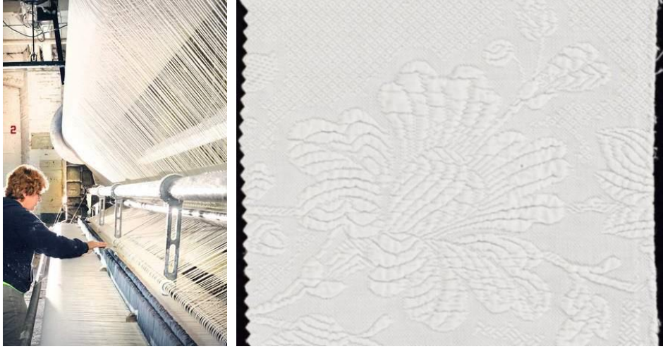
Şekil 2. Jakarlı Dokuma Makinesi (URL-2) Şekil 3. Matelasse Dokuma Kumaş 6 (URL-5)
