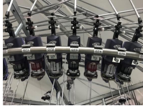
Şekil 7. Örgü sistemi (Özcan, 2019) Şekil 8. Furnisör (iplik tansiyon elemanları) (Özcan, 2019)
