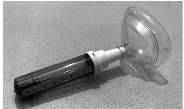
Şekil 2. Clement Clarke International firmasının geliştirmiş olduğu tepe akımmetre.
