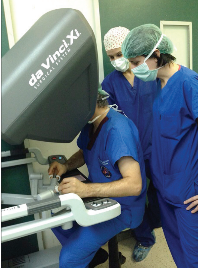
Şekil 1: Cerrah "Konsol" daki robotik kolları kontrol eden bölümlere parmaklarını yerleştirir ve robotik kolları yöneterek cerrahiyi gerçekleştirir.
