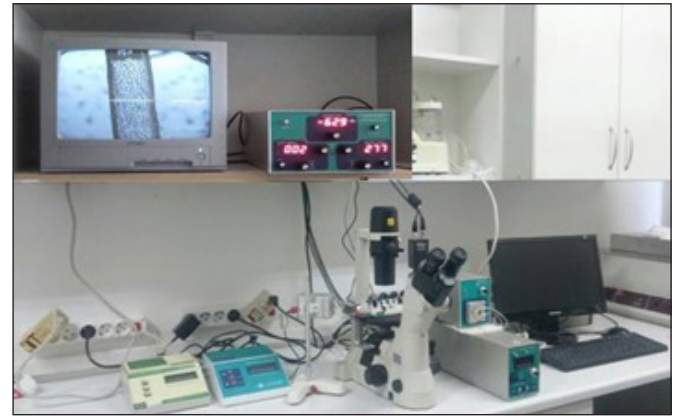
Şekil 5: Sabit basınç ve akım koşullarında damar perfüzyonu gerçekleştirilen ve gerçek zamanlı damar çapı ölçümünün yapıldığı basınç miyografi düzeneği (Ulker ve ark.; Clin Hemor; 2013).
