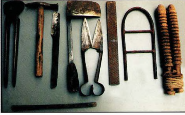
Resim 3: Nabant aletleri (İzmir Selçuk'lu Nabant Ahmet Ersoy'un nabant takımından) 1-Kerpeten, 2-Nallama, 3-Tırnak Keskisi, 4-Santranç, 5-Yele ve Kuyruk kıllarını kesmede kullanılan makas, 6-Tırnak Törpüsü, 7-Ağız ve Diş bakımında kullanılan ağırtık, 8-Yavaşa, 9-Diş Keskisi
