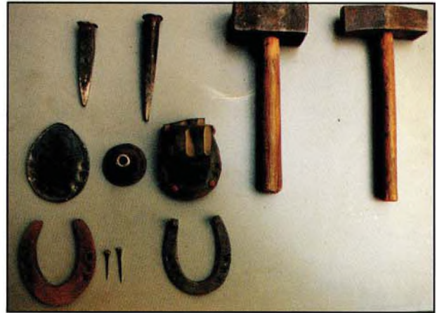
Resim 4: Nalbant âletleri ve nallar (İzmir Selçuk'lu Nalbant Ahmet Ersoy'un nalbant takımından), 1-2) Zımbalar, 3-4) Nal dövme çekiçleri, 5) Osmanlı nalı (düz nal), 6) Mühre, 7) Lastikli naça, 8) Mahmuzsuz nalça (Frenk nalı), 9) Başlı ve başsız muhlar, 10) Mahmuzlu nalça (Frenk nalı)
