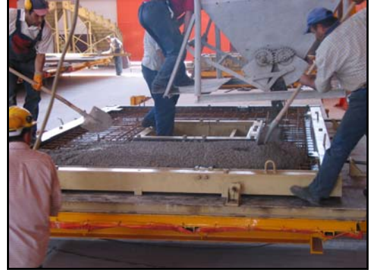
Resim 4. Vibrasyonlu masada prekast cephe paneli üretimi.
