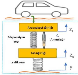
Şekil 1. IRI ölçümü için çeyrek araba modeli (Chen ve ark., 2020)
