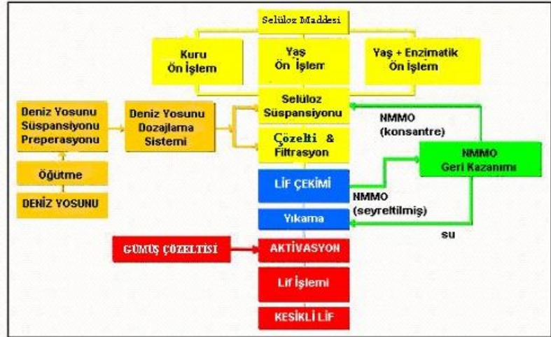
Şekil 8. SeaCell Active lifinin ALCERU prosesi'ne göre üretim basamakları
