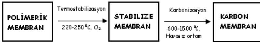
Şekil 23. Polimerik prekürsörden karbon membranların üretimi (5)
