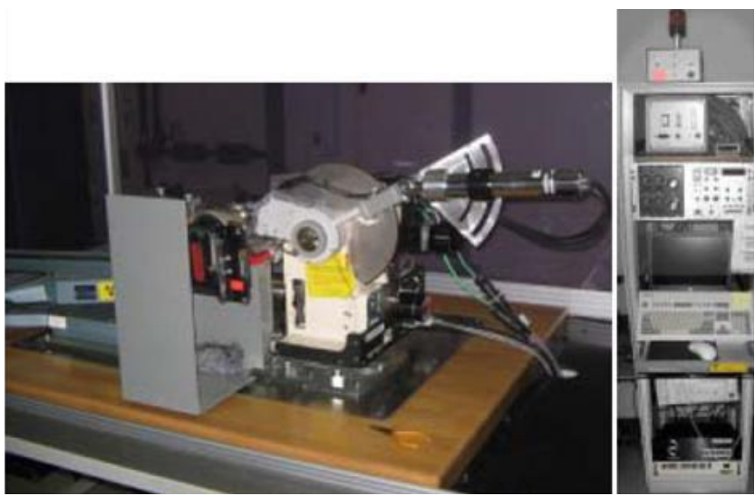
Şekil 4. OMNI geniş açı x-ışını difraksiyon cihazı
