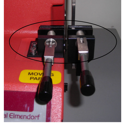
Şekil 2. Dijital Elmendorf cihazında numunenin yerleştirildiđi bölüm
