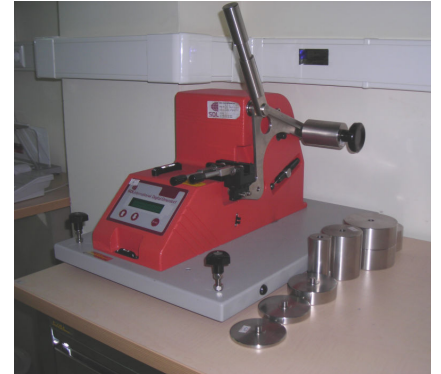
Şekil 3. Dijital Elmendorf Cihazı (Adana KOSGEB)
