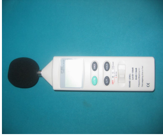
Şekil 3. Gürültü ölçer (dozimetre)
