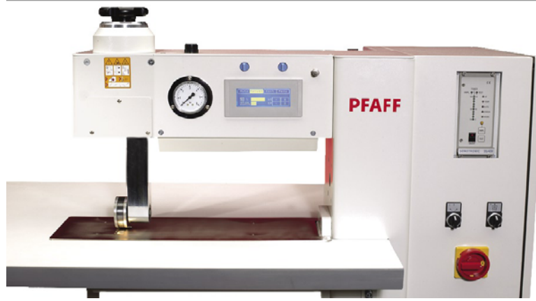
Şekil 3. Pfaff 8310 seamsonic ultrasonik dikiş makinesi (7)
