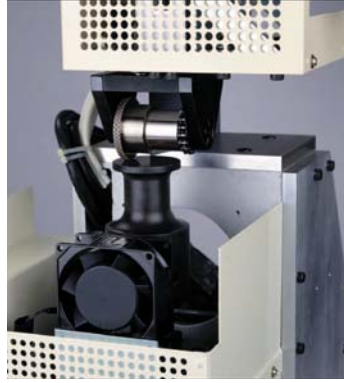
Şekil 1. Yatay konumlandırılmış ve dairesel hareket eden horn (altta) (5)
