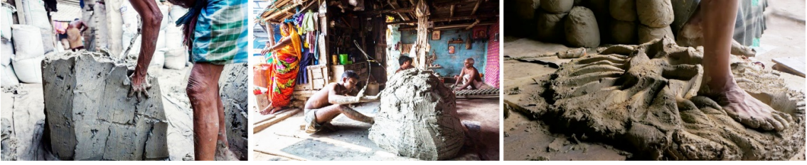
Görsel 8. Kütle haldeki çamurun kesilmesi ve ayakla ezilmesi (Great Big Story, 2020).
