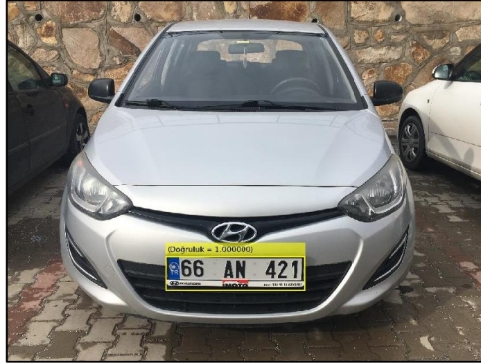
Şekil 8. R-CNN ile bulunan plaka konumu.
