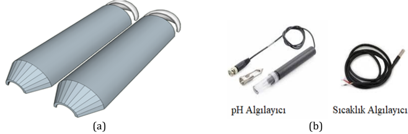
Şekil 4. İştakbe içi parametre ölçer ve algılayıcıları (a) Parametre ölçer kapsülü (b) pH ve sıcaklık algılayıcıları (Intra-rumen parameter meters and sensors (a) Parameter meter capsule (b) Temperature sensor)
