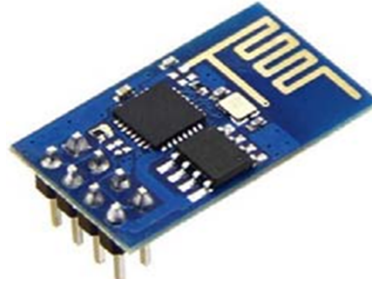
Şekil 5. ESP8266 Wi-Fi modülü (Fuzzy Logic (FL) controller)
