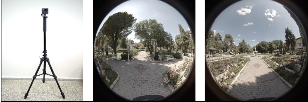
Şekil 7. GoPro Fusion (solda), GPFR-ön (ortada), GPBK- arka (sağda), (S. Tumay kişisel arşivi, 2021).
