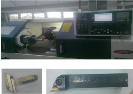
Şekil 1. CNC torna tezgâhı, kesici uç ve takım tutucu
