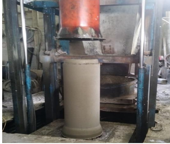
Şekil 6. Üretim Aşamasında Bulunan Beton Boru Figure 6. Concrete Pipe in Production Phase
