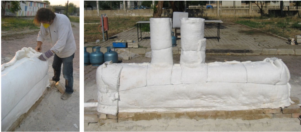
Görsel 9. Fırın heykel iki kat fırın elyafıyla kapatılıyor.
