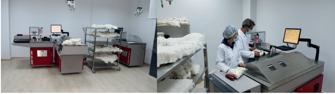
Şekil 1. HVI cihazı ve lif kalite analizi Figure 1. HVI instrument and fiber quality analysis
