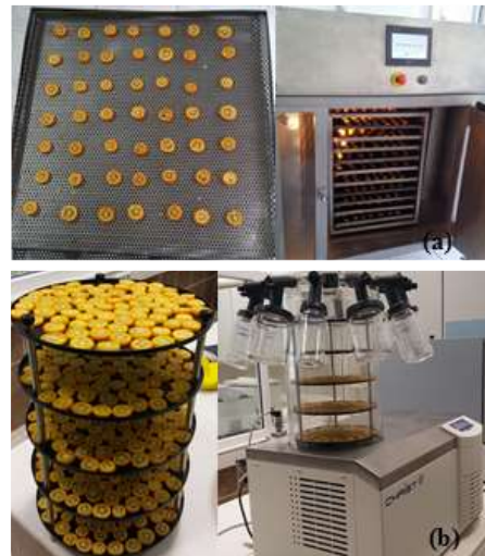
Şekil 1. Kamkat dilimlerinin sıcak hava kurutma (a) ve dondurarak kurutma uygulaması (b) Figure 1. Hot air and freeze drying treatment of kumquat slices
