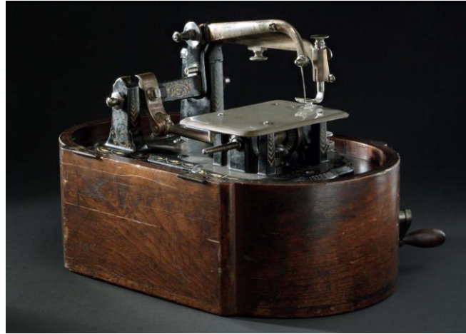
Şekil 3. İlk sanayi dönemine ait Early Wheeler and Wilson marka manuel dikiş makinası (Early Wheeler and Wilson machine, 2021).
