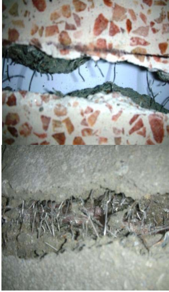
Şekil 10. Lifli karolarda kırılma ara yüzeyi (karo ön ve arka yüzü).
