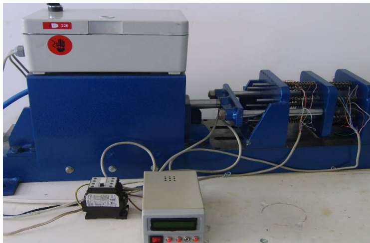
Şekil 10. Yük tekrar sayısını belirleyen sayaç sistemi
