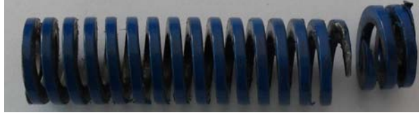
Şekil 11. Test sonucunda kırılmış dikdörtgen kesitli yay
