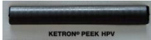
Şekil 3. HPV-PEEK polimer kompoziti pim numunesi
