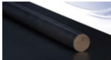
Şekil 1. HPV PEEK polimer kompozitin ekstrüde edilmiş çubuk görüntüsü
