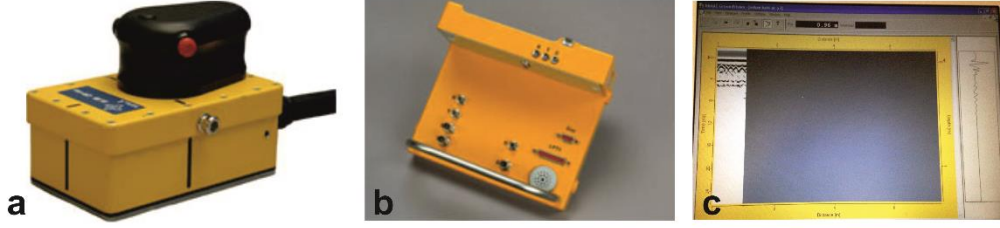
Şekil 1. GPR sisteminin üç ana bileşenin gösterimi; a) Verici ve alıcı anten (1600 MHz) b) Antenden gelen verileri sayısallaştıran kontrol ünitesi c) Ölçüm sırasında ham verinin görünümü
