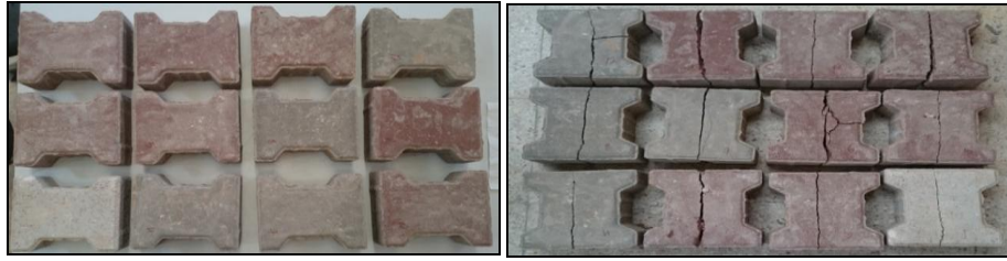
Şekil 3.(4). Parke taş numunelerinin deney öncesi ve sonrası görünüşleri
