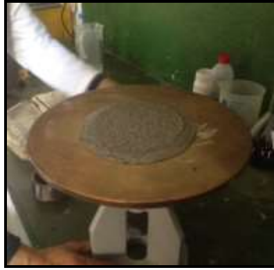
Şekil 1. Yayılma tablası deney düzeneği
