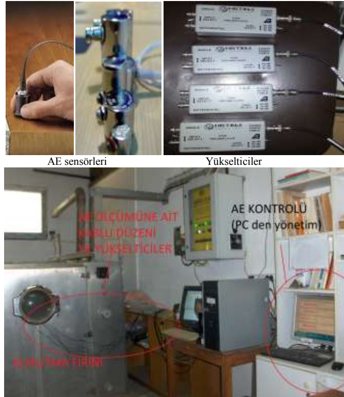
Şekil 5. Akustik Emisyon Uygulama Ekipmanı Ve Kurutma Fırınına Adaptasyonu (Acoustic emission equipment and connection apparatus to drying kiln)
