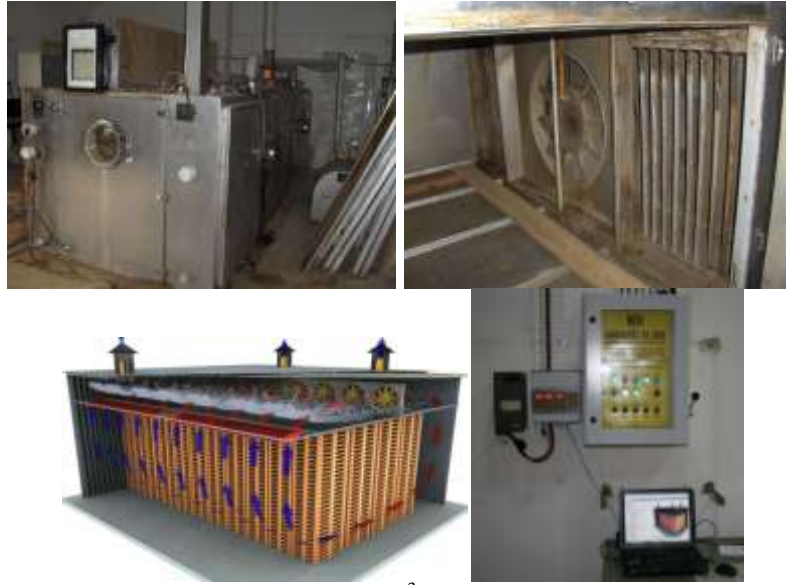
Şekil 3. Kurutma denemelerinde kullanılan 1m 3 net kereste kapasiteli klasik kurutma fırını, iç ekipmanı ve otomasyonu (Conventional drying kiln with 1m 3 capacity, interior equipment and automation for experiments)
