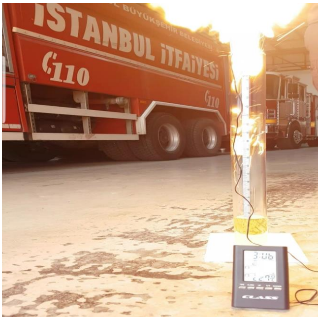
Şekil 5. Etanol deneyinde buharlaşan yanıcı gazın tutuşturucu ile temasındaki patlama anı.
