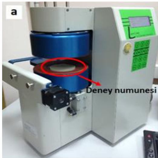
Şekil 4. a) Lasercomp Fox 50 ısı iletim katsayısı ölçüm cihazı, b) Cihazın çalışma prensibi.
