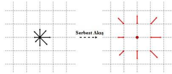
Şekil 2: D2Q9 Modelinde serbest akış evresi (Free Streaming in D2Q9 Model)
