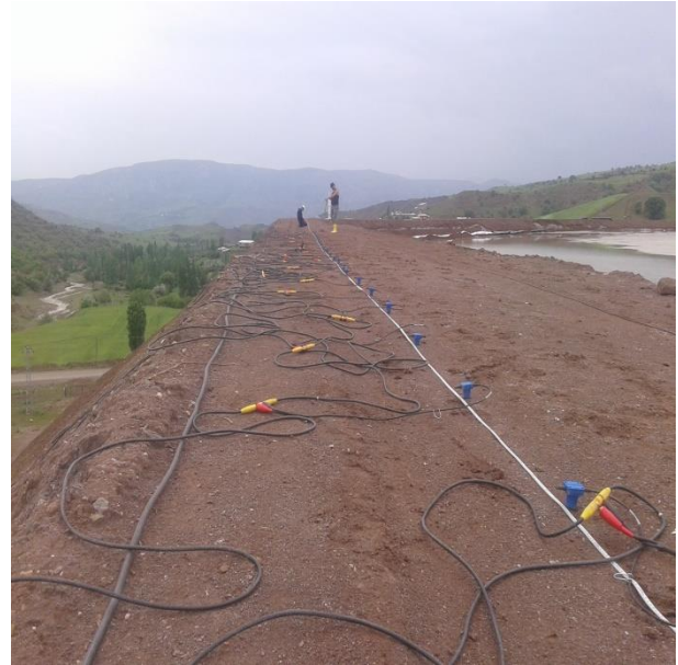
Şekil 10. Atık barajı kretinde yapılan sismik kırılma ve MASW çalışmaları
