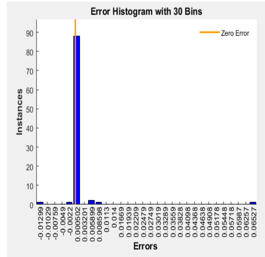
Şekil 12. Yapay Sinir Ağı Modelinin 30 Bins error Histogram (30 Bins error of ANN model)
