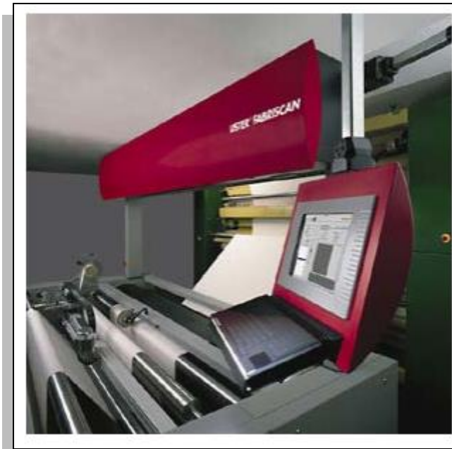
Şekil 5. Makina odaklı hata tespit sistemi (Dockery, 2001)
