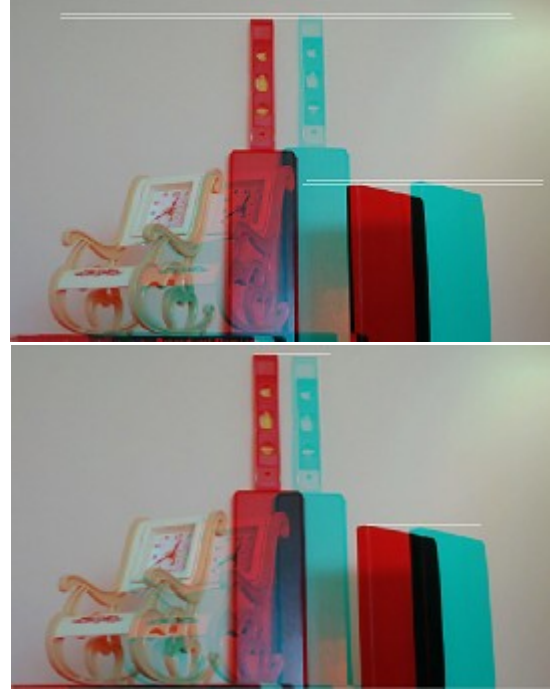
Şekil 7. Düzeltmeden önce ve sonraki üst üste bindirilmiş görüntüler (Over lapped images before and after rectification)
