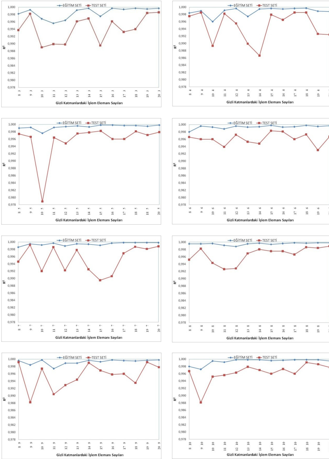
Şekil B.1. İki gizli katmandaki işlem elemanı sayısının değişiminin YSA tabanlı modelin performansına etkisi
